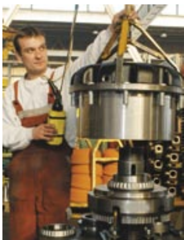
Kép januárból: a Marmon-Herringtonnak készül a 683-as mellső futómű
